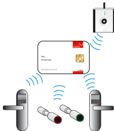
Abbildung Verteilung der Daten an die Schließsysteme mittels ID-Träger
